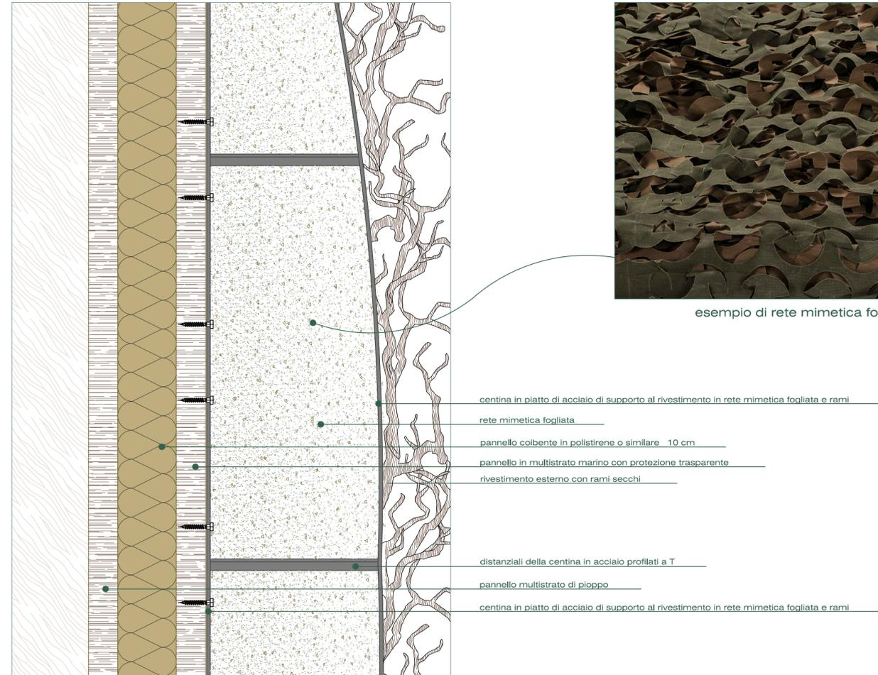
dettaglio rivestimento \_ scala 1:5
