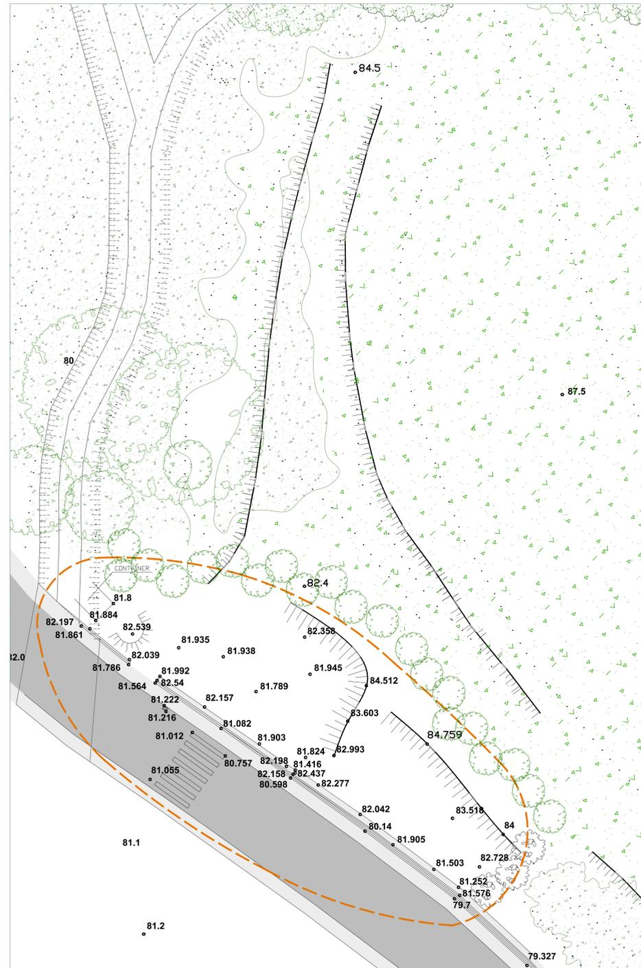
STATO DI FATTO\_planimetria\_scala 1:200 (con rilievo di dettaglio)
